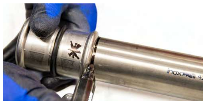
Figura 32 - Marcatura della profondità d'innesto con raccordo
